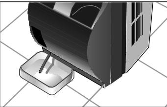
Om het transport te vergemakkelijken, is het apparaat voorzien van rollen. Voordat het apparaat bij het transport schuin gehouden of gekanteld wordt: het water uit het reservoir in het apparaat laten weglopen via de afvoerslang die aan de onderkant van het apparaat wordt aangesloten.
