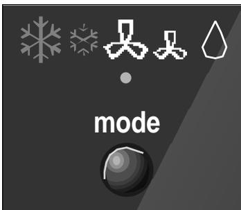
Sur cette fonction, l'air recommence à circuler à l'intérieur de la pièce en le passant par des filtres purificateurs.
