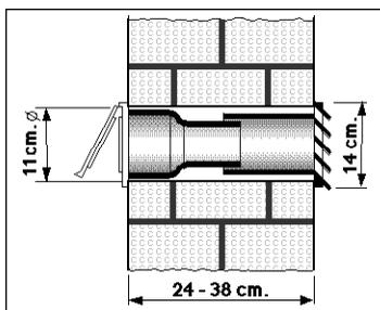
Voor een vaste installatie hebt u het extra toebehoren "raam/ muurdoorvoer" nodig. Dit is onder bestelnummer **B1 RKZ O6009** in de vakhandel verkrijgbaar
